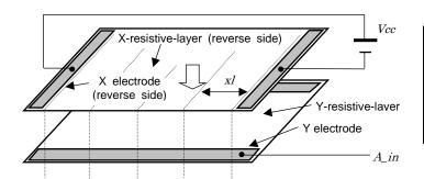
Vcc = 5.0V**Output Data** χl A\_in 0V Α 0000h (Min.) В 1.25V 00FFh С 2.5V 01FFh 3.75V 02FFh D Ε 5V 03FFh (Max.
